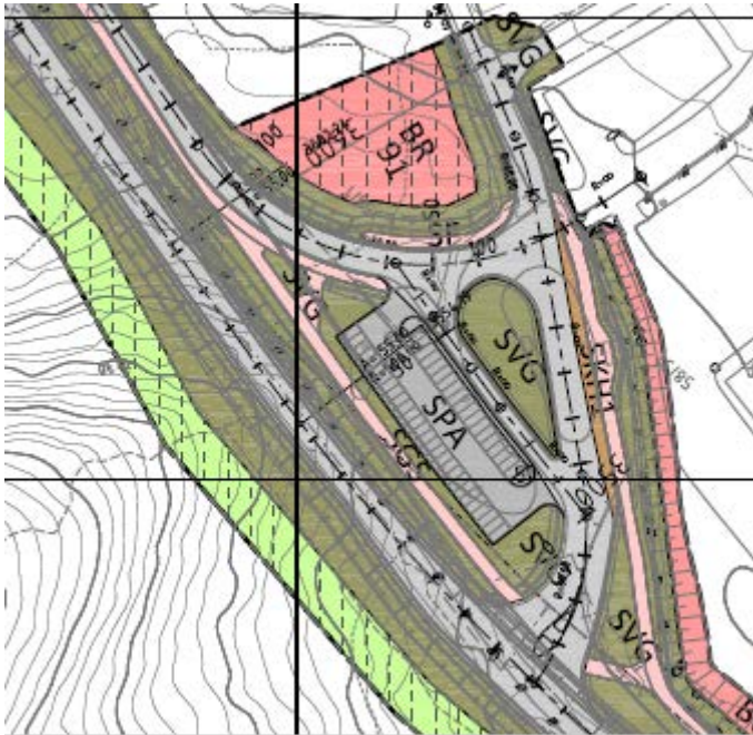
Figur 15: Utsnitt av reguleringsplanen ved Stokksund skule (det grå er vegareal/p-plass, det rosa er g/s-veg, det brune er kollektivhaldeplass, det mørke grøne er «anna trafikkareal» og det lysgrøne er LNF).
