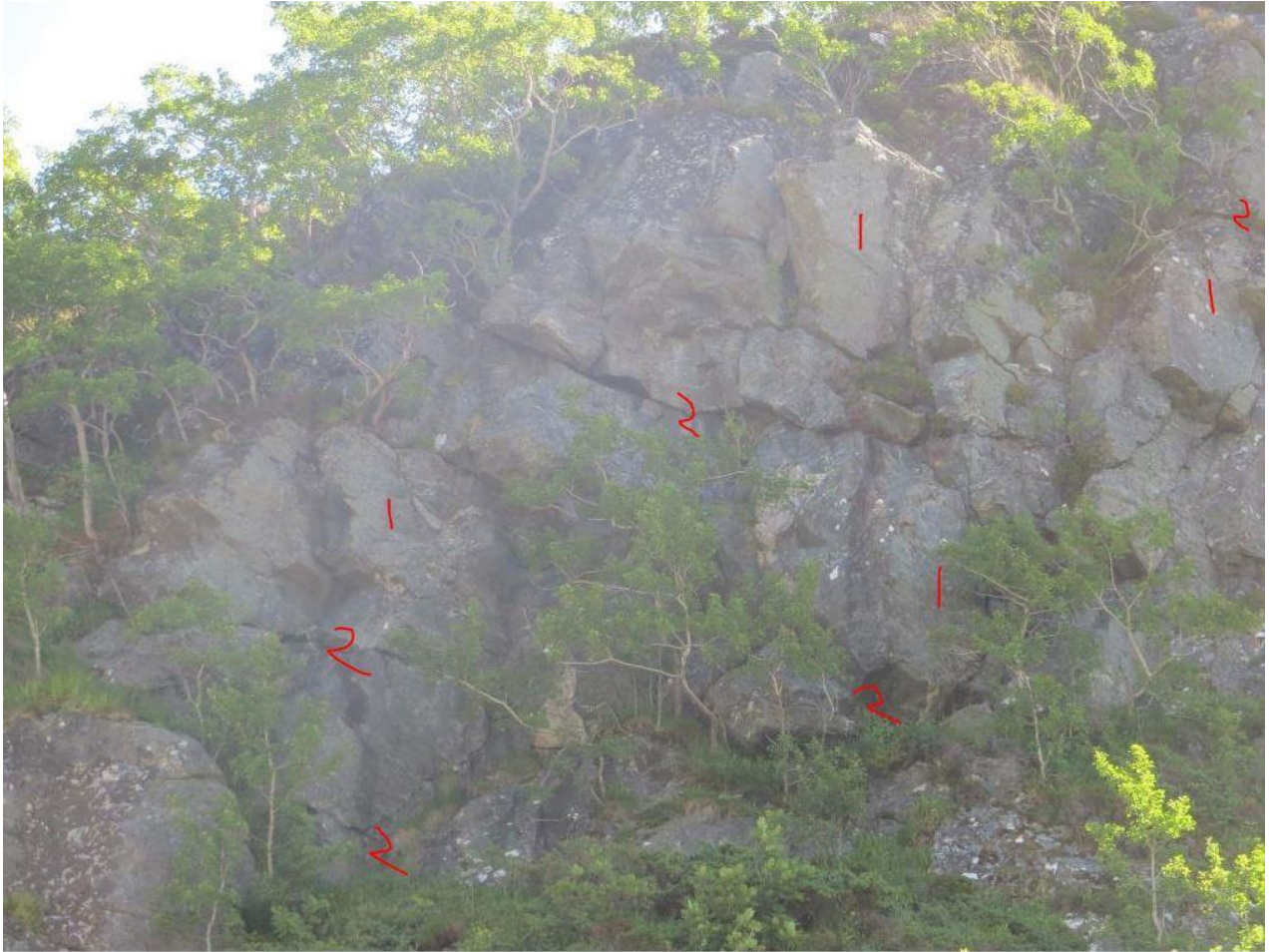
Figur 20: plan langs primært sprekkesystem 1 og sekundære sprekkesystem 2 i område C figur 7. Dette er fra område merket 5 og 6 i figur 15.
