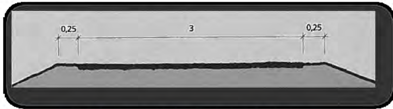
Figur 11: Illustrasjon gang- og sykkelveg. 3 meter med asfalt og 0,25 meter med vegskulder på kvar side.
