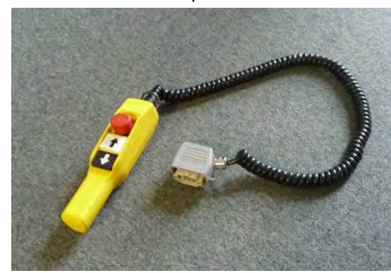
Håndkontroll med nødstop
