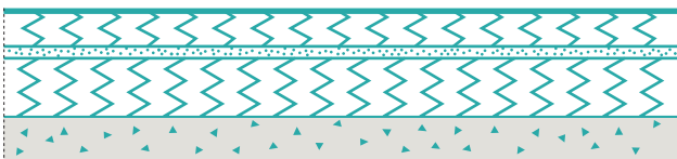
Prinsipiell oppbygging av blandingselastiske gulv
