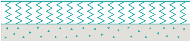
Prinsipiell oppbygging av punktlastisk gulv
