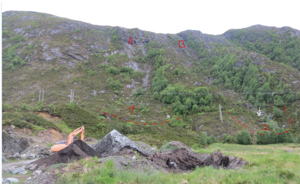
Figur 15 Oversiktsbilde viser øvre del av fjellet, som også ut fra topografiske trekk definerer løsneområde for steinsprang (A og B). Historisk steinsprang ligger godt synlig i terrenget rett i utløpsarealene (1 og 2). Hvit pil i utløpsareal 2 viser lokasjon for siste blokken som kom ned for få år siden.
