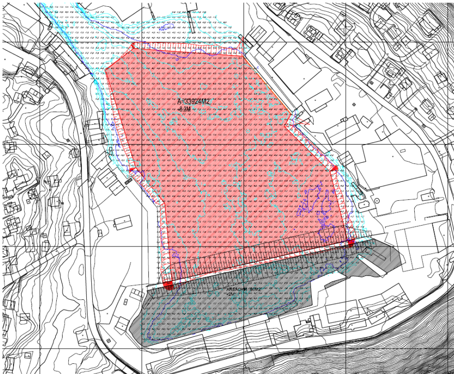
Figur 1: Tenkt plassering av deponi (svart skravur lengst i sør) og område for utdyping av hamnebasseng til seilingsdjup (-8,3m). NB! Innseiling kommer i tillegg.
