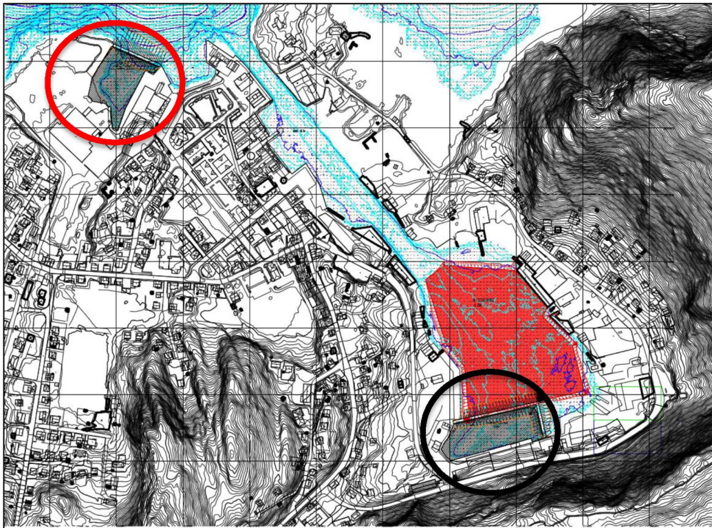
Figur 3 Utsnitt av plan for Fosnavåg havn. Område som skal mudres er skravert med rødt. Deponialternativer er markert med mørk skravur. Deponiområdet i indre havn er markert med sort sirkel, mens deponiområdet i ytre havn er markert med rød sirkel.
