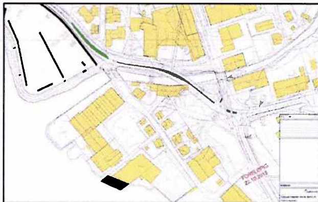
Figur 21 - Alternativ 6 - Kanalisering av alle kryss på E39.
