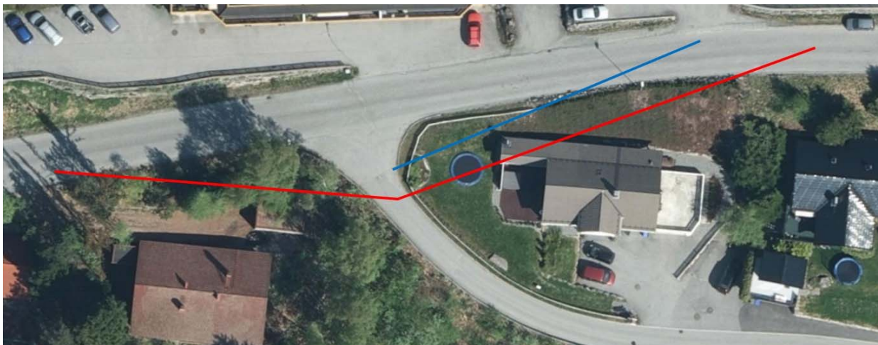
Figur 19 Frisiktlinjer i krysset mellom «Bøkevegen» og «Røyslidvegen»
