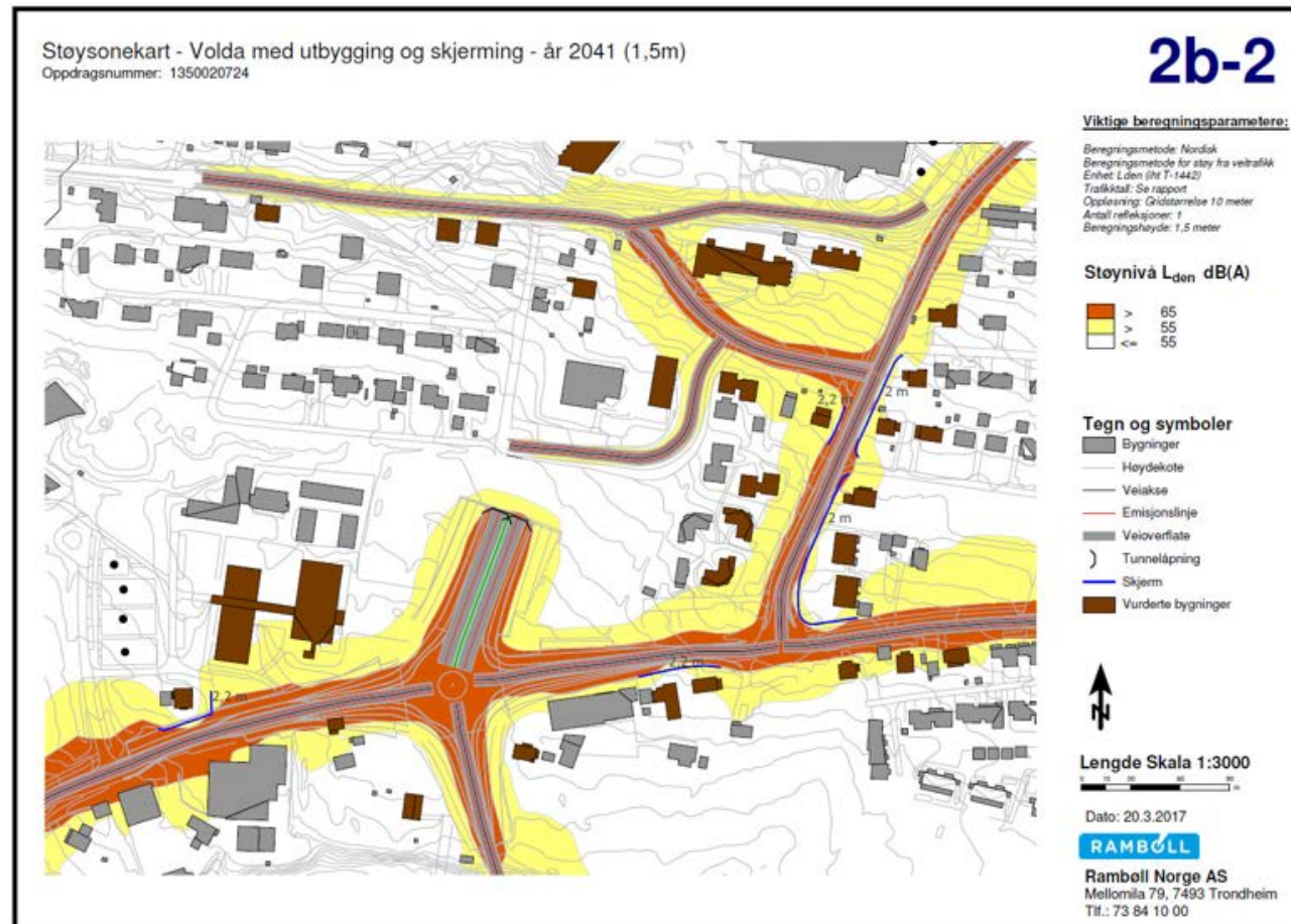
Figur 66 – Støysonekart for Volda målt 1,5 meter over terreng. Plassering og utstrekning av aktuelle skjermar vist med blå strek
