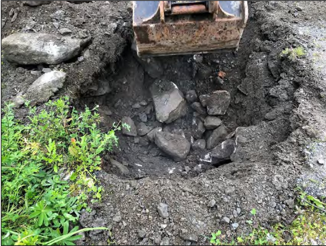
Figur 10 Punkt PG5. Sjakten er gravd ned til ca. 0,8 meter. Massene består av sprengstein, med sand og grus. I denne sjakten ble det registrert bålukt, sot og noe avfall.
