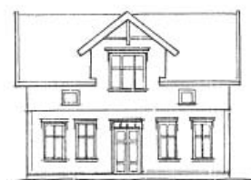
Sveitserstil i 1910. (Krysspostvindauga og rik detaljering.)
