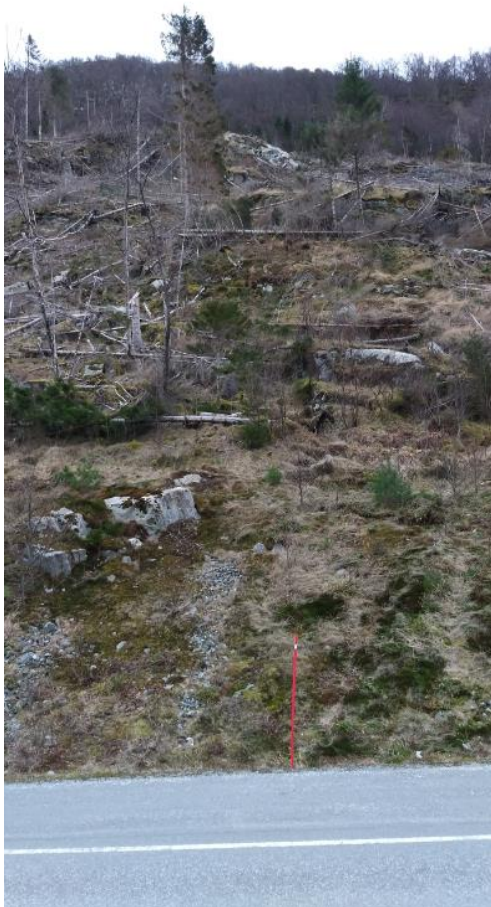
Figur 22 Området sett fra veien, med øvre løsneområde definert med vegetasjon, fremkant av slette ved tydelig berg, nedre løsneområde fra berg og nedover og utflating mot veien.
