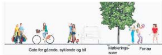
SAMBRUKSGATE: Slik er prinsippet for utforming av en «sambruksgate». Her er lov å kjøre, men på premissene til de myke trafikantene. Danske byer har gode erfaringer med slike. ILLUSTRASJON: GATEBRUKSPLANEN
